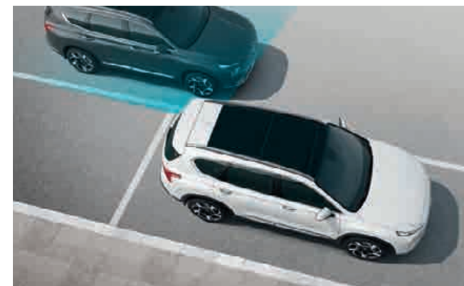
Aktivní sledování mrtvého úhlu vnějších zrcátek (BCA) Systém vás pomocí radarových senzorů ve spodní části zadního nárazníku varuje před provozem v tzv. mrtvém úhlu. Pokud v takové situaci použijete ukazatel směru, ozve se výstražný signál a selektivní brzdou silou se zabrání kolizi.
