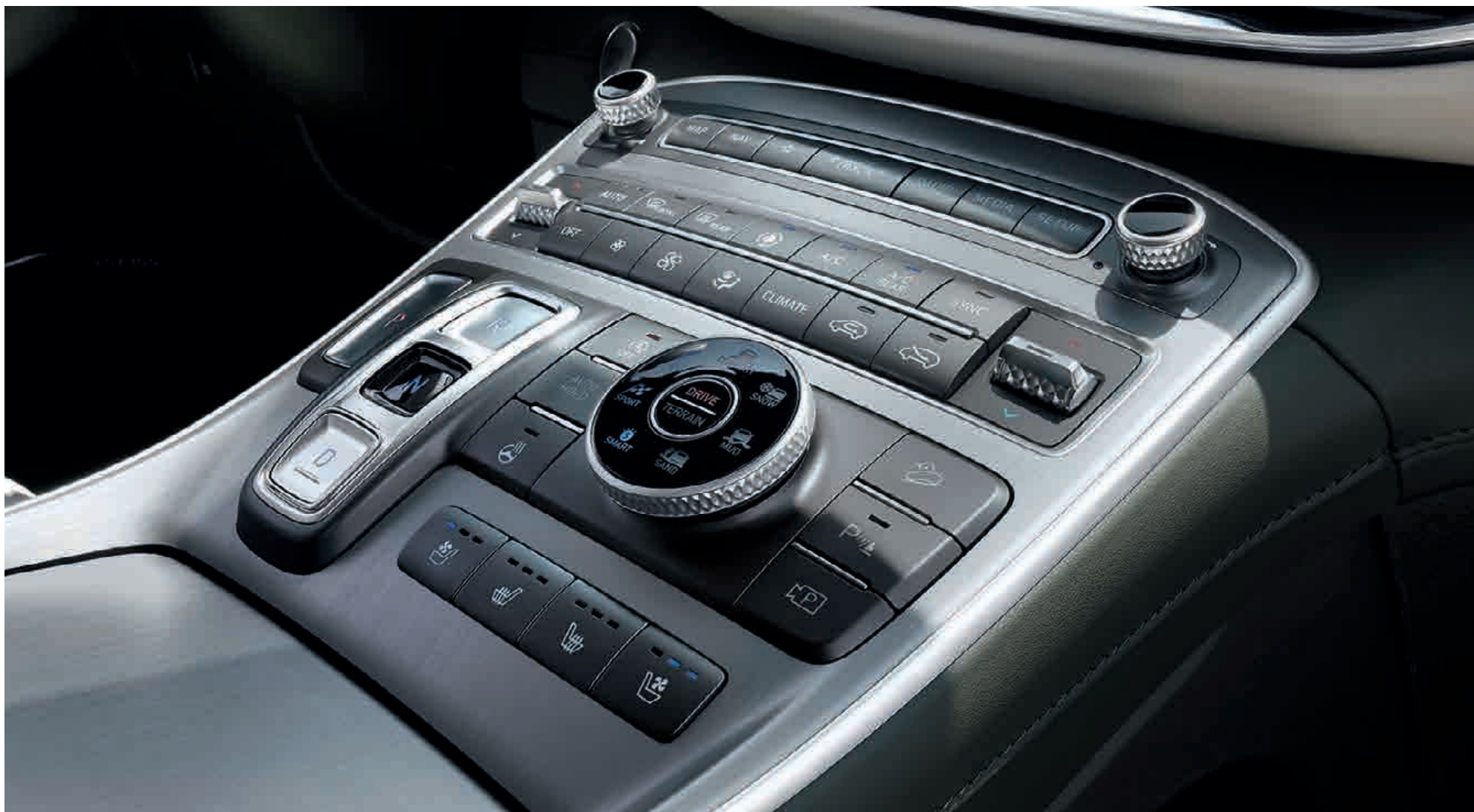
„Plovoucí“ prémiová středová konzola s elektronickým ovládáním převodovky tlačítky „Shift by Wire“
