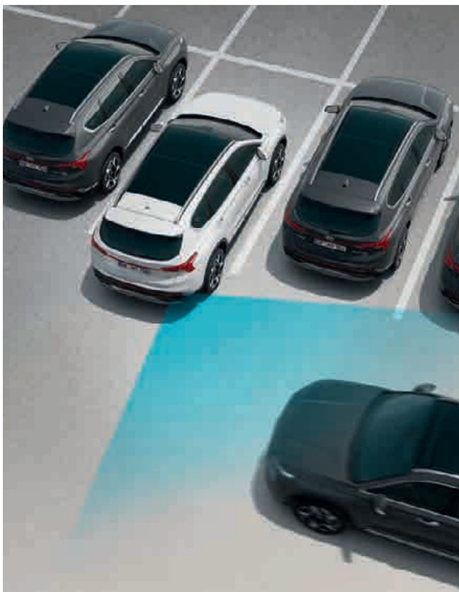
Aktivní upozornění na projíždějící vozidla při couvání (RCCA) Při vyjíždění couváním z oblastí se sníženou viditelností systém nejen varuje řidiče, pokud se z boku přibližují jiná vozidla, nýbrž také automaticky aktivuje brzdy.
